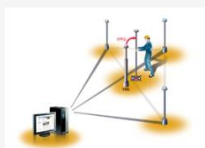
3. 이동국은 마치 지근거리의 기준국을 이용하는 것과같이 VRS의 데이터를 전송받아 RTK측량을 수행
